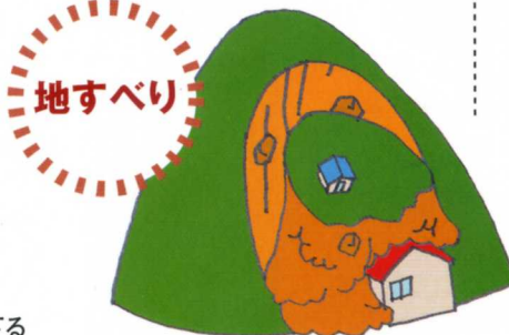
▲断続的に斜面が滑り出す
