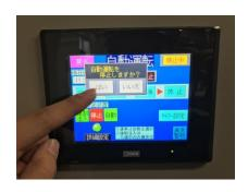
「停止」をタッチし、 自動運転を停止しますか?にて 「はい」をタッチ 数秒後洗浄工程に入り、 洗浄工程を経て停止します。
