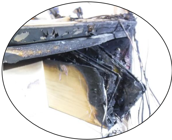
焼損したタブレット端末置場
