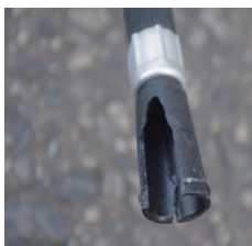
× ノズルの破損
