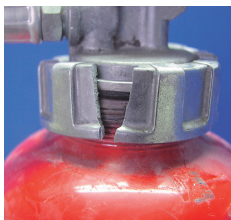
× キャップの破損
