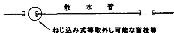
第4-11-2図 散水管のスケール等を取り除くことができる構造の例
