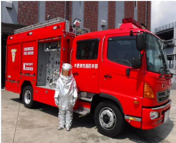
化学小隊が乗車する化学車には水、泡消火剤およびそれらを使って消火活動するのに必要な資機材が積載され、車両上部には放水銃を装備し、水では消火不能や困難な油火災に対し水と薬液を混合させた混合液を放水し対応します。化学小隊はそうした特殊な状況での火災に対応する部隊で、石油コンビナート火災、車両火災、航空機事故等ガソリンなどの危険物火災の最前線で活動します。
