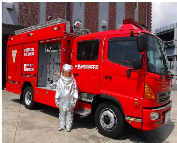
化学小隊が乗車する化学車には水、泡消火剤およびそれらを使って消火活動するのに必要な資機材が積載され、車両上部には放水銃を装備し、水では消火不能や困難な油火災に対し水と薬液を混合させた混合液を放水し対応します。化学小隊はそうした特殊な状況での火災に対応する部隊で、石油コンビナート火災、車両火災、航空機事故等ガソリンなどの危険物火災の最前線で活動します。また、活動場所は通常の火災現場よりも高温になりやすいため、隊員も高温にも耐えられる耐熱服を着装し活動します。
